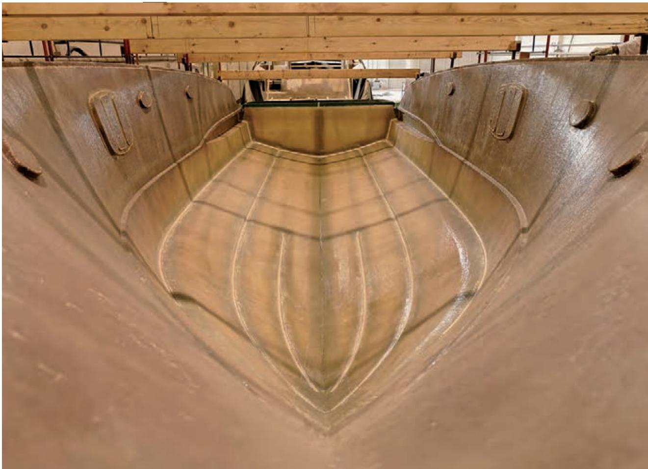
*Detalle de casco construido por infusión.*
