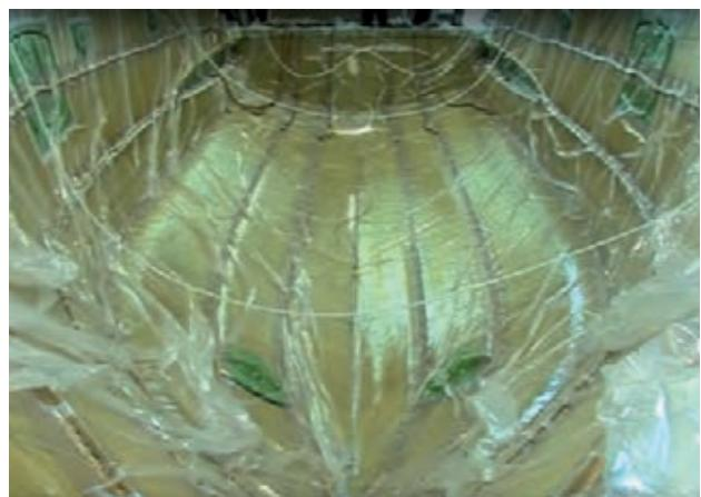
*Instantánea del proceso de infusión del casco de una embarcación Astondoa en la factoría de Almansa*
